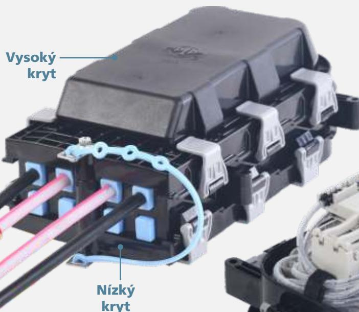
Spojka COYOTE® STP-XL velikosti M - umožňuje osadit 4 nebo 6 kazety a provářit 96 nebo (v oboustranné konfiguraci) 144 samostatných vláken. Spojka má z jedné strany vysoký kryt a možnost osadit 4 kazety, z druhé strany nízký kryt. Spojka má 8 nezávislých vstupních portů pro kabely a trubičky, které je nutné osadit těsněním STP. Zobrazená spojka je v ribbonovém provedení.
